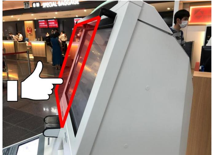
センサーから出る赤外線が指を感知して触れずに画面を操作
