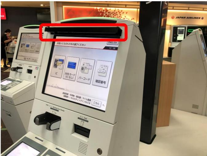
画面上部にセンサーを設置するだけで非接触化を実現
