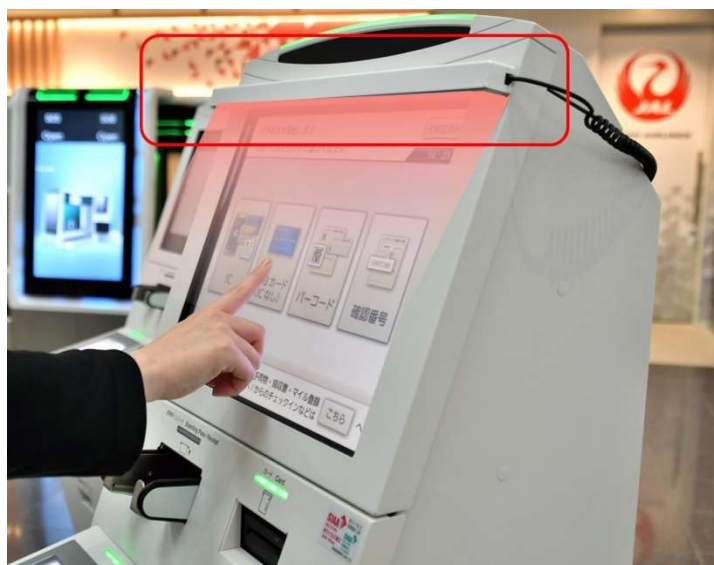
赤外線によって自動チェックイン機のタッチパネルを非接触化
